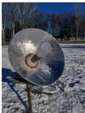
Рис. 1. Зразки освітньої продукції: а) діюча модель геліоустановки «Квітка Сонця»; б) логотип пристрою, що уособлює його провідну ідею. Джерело: матеріали авторів
